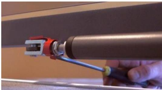
1. Retire la rosca del eje de fijación con una herramienta adecuada, como por ejemplo un destornillador, una regla, un abrebotellas o similares.
